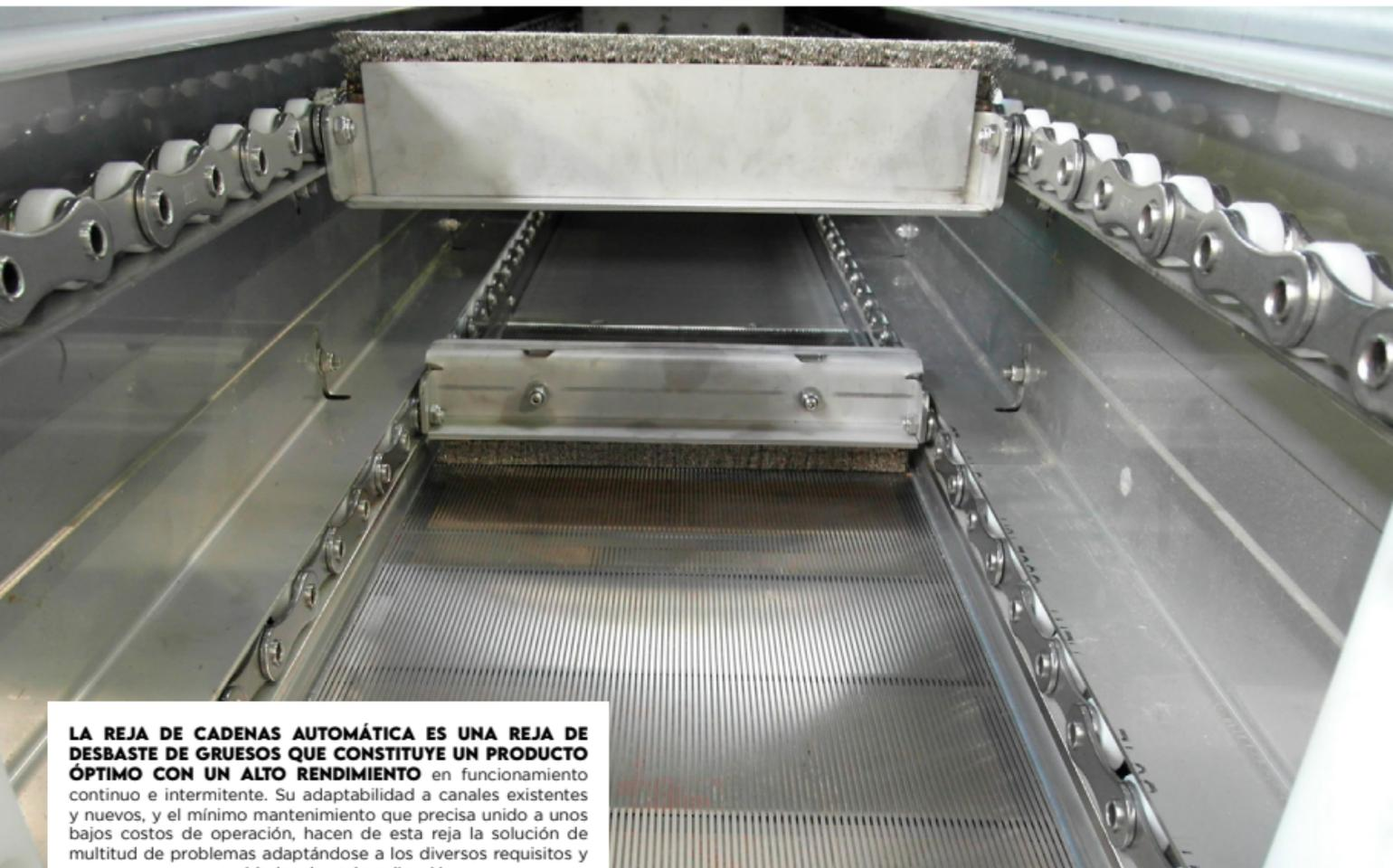
**LA REJA DE CADENAS AUTOMÁTICA ES UNA REJA DE DESBASTE DE GRUESOS QUE CONSTITUYE UN PRODUCTO ÓPTIMO CON UN ALTO RENDIMIENTO** en funcionamiento continuo e intermitente. Su adaptabilidad a canales existentes y nuevos, y el mínimo mantenimiento que precisa unido a unos bajos costos de operación, hacen de esta reja la solución de multitud de problemas adaptándose a los diversos requisitos y necesidades de cada aplicación.
